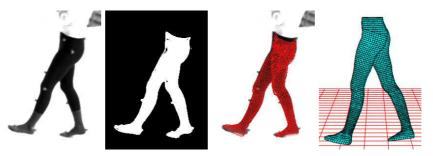
**Fig. 13.9. From left to right:** (a) Original image. (b) Silhouette. (c) Estimated pose. (d) 3D model.
